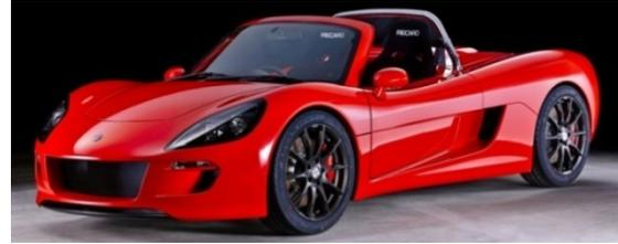
2 人乗りのオープンカータイプで、最高速度は 180km/h。1 回の充電による航続距離は 120km で、走りを楽しむスポーツカーとしては十分な容量のバッテリーを積んでいます。
